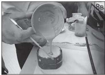
■Рис. 8. Технологический процесс получения силиконовой массы требуемого оттенка по методу проверки-опровержения (а-е)
